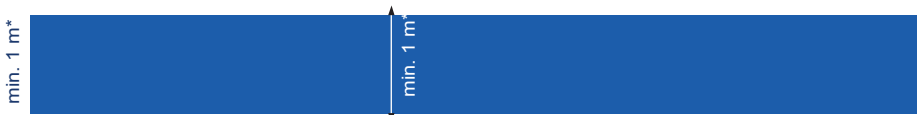
Cycling track on independent lane or preferential lane. Ciclovías independientes o carriles reservados. only for short sections / sólo para tramos cortos
